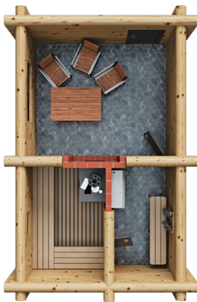
Рис. 8 Пример установки печи в защитном кожухе из кирпича с функцией обогрева комнаты отдыха и моечного отделения
