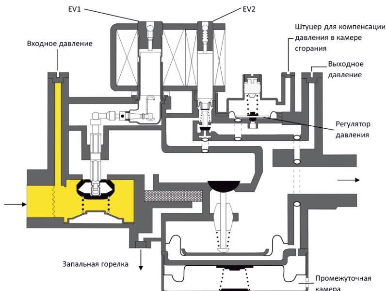
Рис. 4 Устройство клапана SIGMA 840
