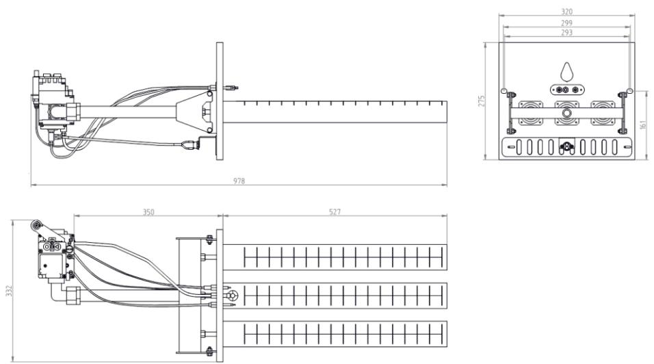
Рис. 2 | Общий вид и габариты ГГУ 60
