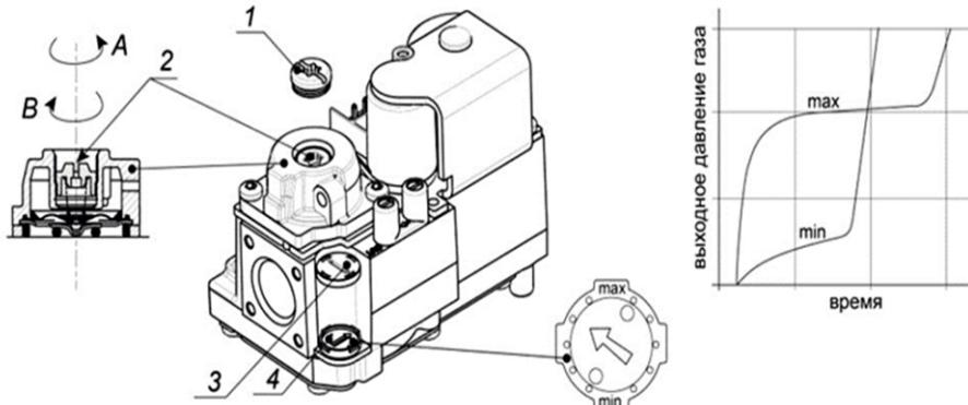
Регулировка плавности открытия
