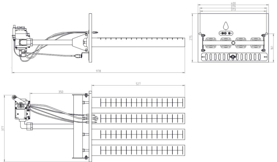
Рис. 3 | Общий вид и габариты ГГУ 80
