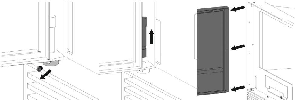
1 Выкрутите фиксирующий винт из опорной втулки
