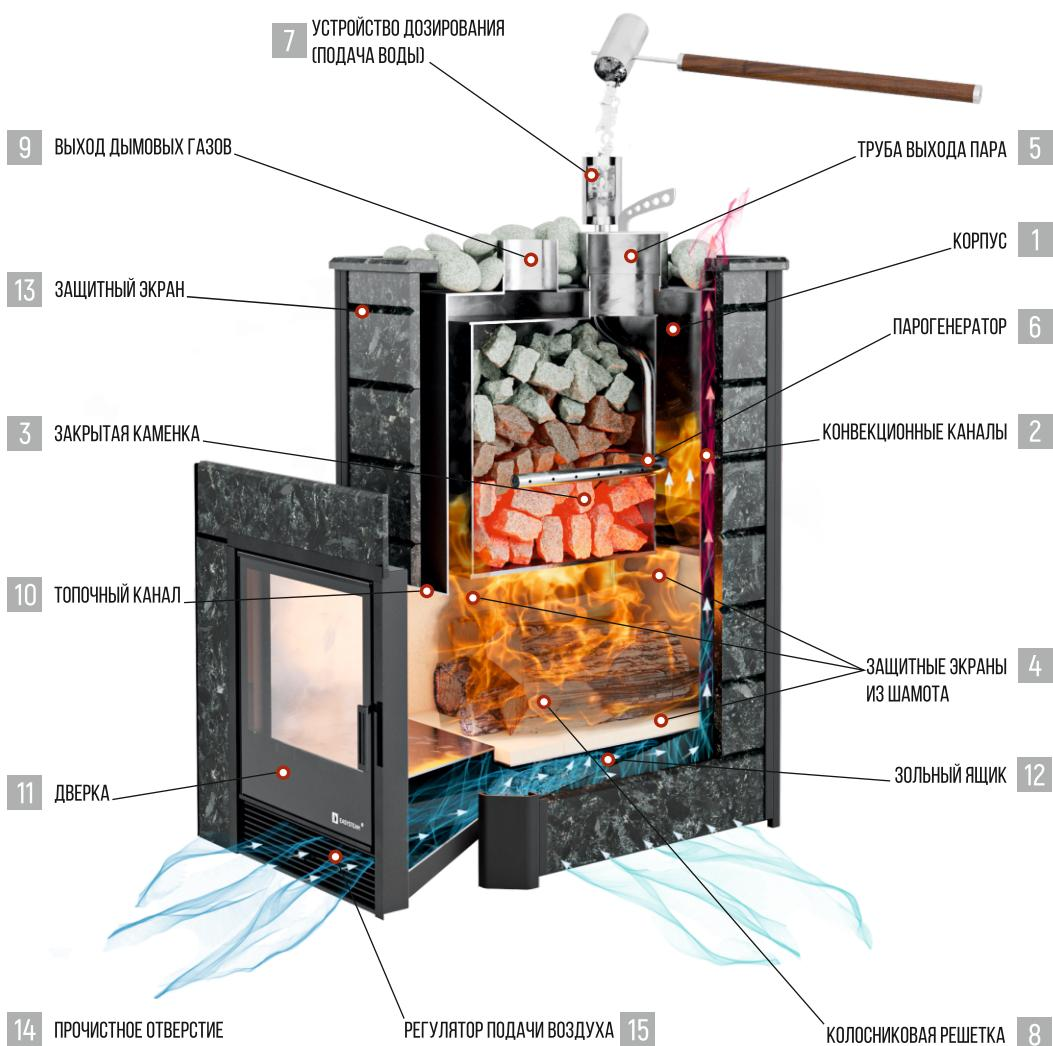
Банные печи компании «ИзиСтим» выполнены из нержавеющей, жаропрочной стали с содержание хрома не менее 17%. Корпус печи (поз.1) представляет собой гнуто-сварную конструкцию сложной геометрии, с дополнительной установкой усиливающих конструкции элементов, изготавливается из жаропрочной стали толщиной 3 мм. С внешней стороны по боковым стенкам печи располагаются конвекционные каналы (поз.2).
