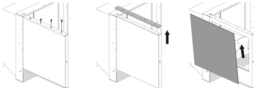
1 Выкрутите четыре фиксирующих винта
