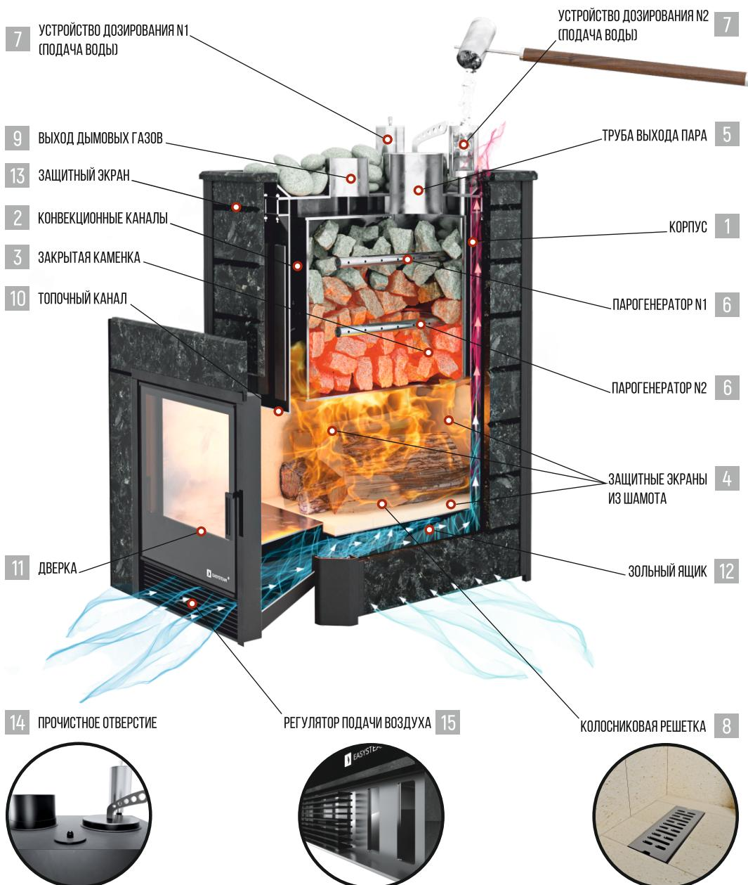
Банные печи компании «ИзиСтим» выполнены из нержавеющей, жаропрочной стали с содержание хрома не менее 17%. Корпус печи (поз.1) представляет собой гнуто-сварную конструкцию сложной геометрии, с дополнительной установкой усиливающих конструкции элементов, изготавливается из жаропрочной стали толщиной 4-8 мм. С внешней стороны по боковым стенкам печи располагаются конвекционные каналы (поз.2).
