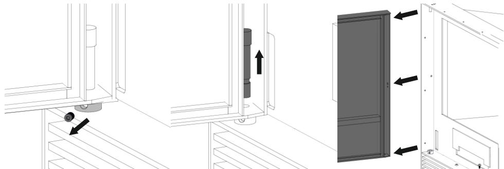
1 Выкрутите фиксирующий винт из опорной втулки
